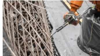
Roboterassistierte Freiformwicklung eines Flachsfaser-Prototypen. © ITKE/ICD
