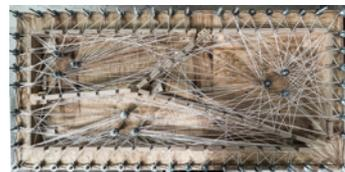
Prüfung der mechanischen Eigenschaften des Flachsmaterials. © ITKE/ICD
