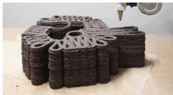
3D-gedruckter Cellulose-Prototyp. © CITA
