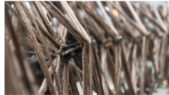
Roboterassistierte Freiformwicklung eines Flachsfaser-Prototypen\_Detail. © ITKE/ICD
